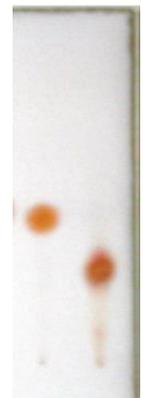
A sílica gel utilizada em cromatografia em camada delgada tem caráter polar e a separação dos componentes se dá por adsorção. Partindo do princípio de que polar dissolve polar
